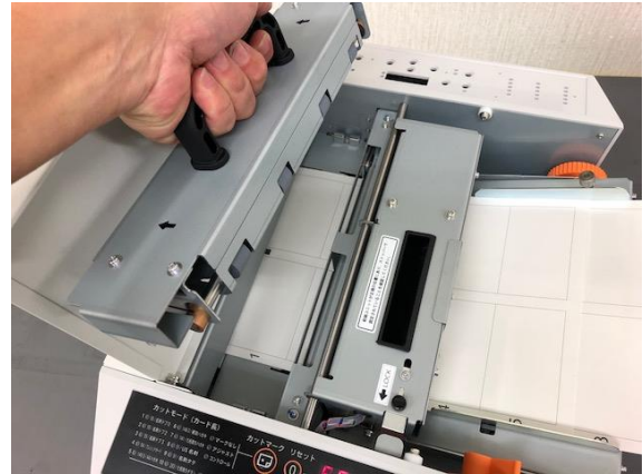
加圧ユニット取り外し
