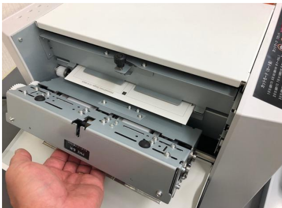
スリッターユニット取り外し
